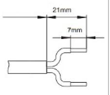
Usare solo cavi 2x1.00 mm2 del tipo H05RN-F con rivestimento tessile o senza
